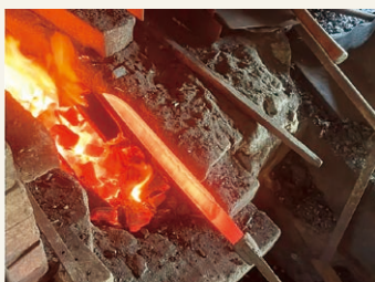
▲短刀の刃文を作る工程
